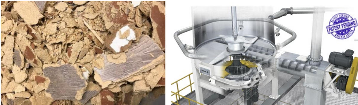
Abbildung 5: Links, vorgebrochenes HDF/MDF (beschichtet); Rechts, Hydrolysationseinheit (Mohr und Krug 2022).
