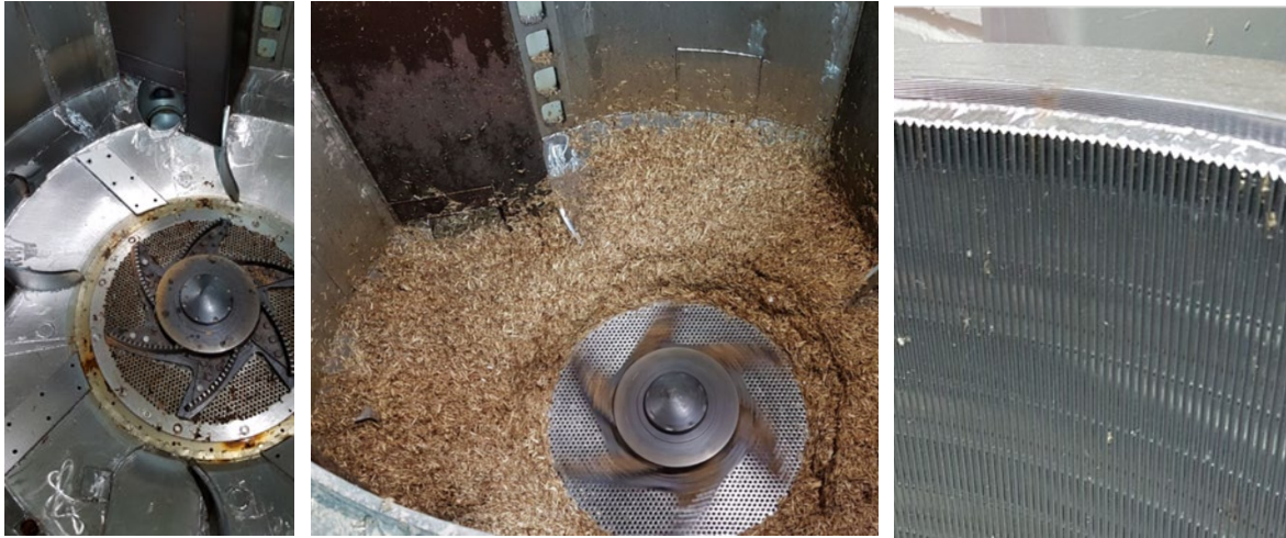
Abbildung 6: Links, Pulper-Einheit; Mitte, Pulper-Einheit mit Material; Rechts: Screening-Einheit (Mohr und Krug 2022).
