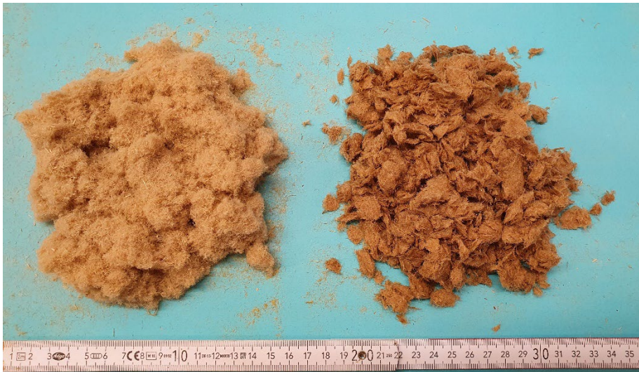
Abbildung 8: Faserstoff, Links aufbereitet nach Trocknung; Rechts im Anlieferungszustand, feucht (Mohr und Krug 2022).
