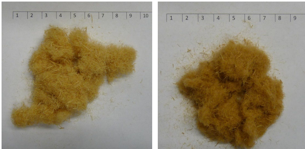
Abbildung 2: Faserstoff hergestellt im modifizierten TMP-Prozess des IHD, Links aus Altholz; Rechts aus Alt-MDF.
