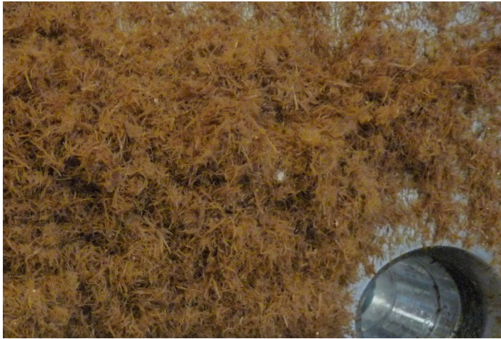
Abbildung 4: Faserstoff hergestellt aus Alt-MDF in der Steam-Explosion-Anlage des IHD TMP-Prozess.
