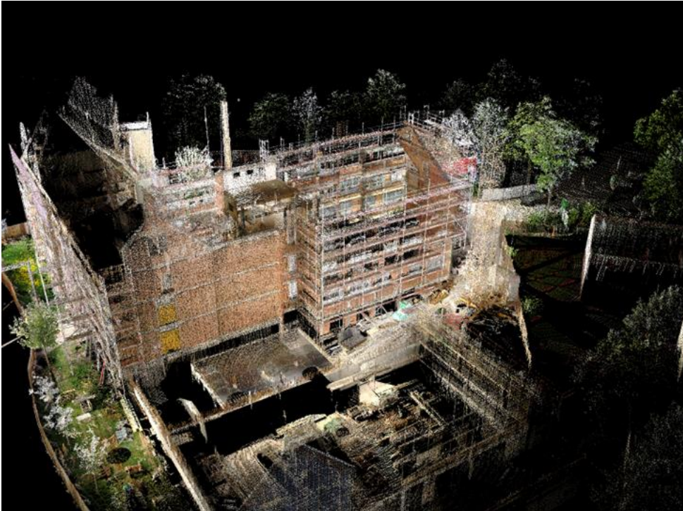
Abbildung 6: Digitales Gebäudeaufmaß mit 3D Laserscan
